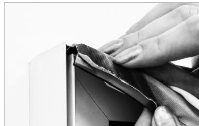
Mit einer der oberen Ecken anfangen und den Keder mit beiden Händen um 90° nach innen klappen
