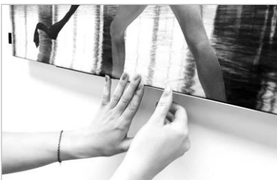
Nach den Ecken den Keder in der Mitte des Profils in die Nut drücken, aber nicht streichen
