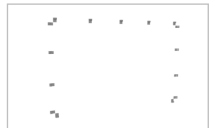
Wiederholen Sie die Schritte bis alle Z-Halter oben, rechts und links gesetzt sind.
