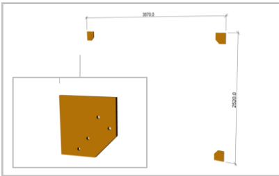
Maße des Rahmens anzeichnen. Bohrschablone an allen 4 Ecken ansetzen und Löcher markieren.
