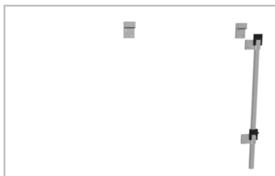
Hilfstoel verwenden, um die weiteren Z-Halter zu befestigen.
